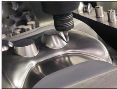
El husillo en línea de accionamiento directo y 12 000 rpm de Haas, en combinación con el Control CNC de alta velocidad HAAS, con función "Look Ahead", garantiza la precisión y acabado superficial de calidad necesario para las industrias del molde y de alta precisión.
