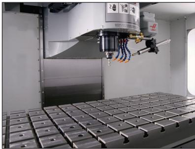
Las máquinas de la serie de moldes VM están equipadas de una mesa especial, provista de ranuras horizontales y verticales, en la dirección de los ejes X e Y, así como de agujeros roscados de precisión, para amarrar cualquier pieza o utillaje.
