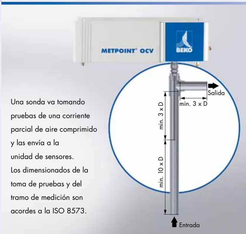
Una sonda va tomando pruebas de una corriente parcial de aire comprimido y las envía a la unidad de sensores. Los dimensionados de la toma de pruebas y del tramo de medición son acordes a la ISO 8573.
