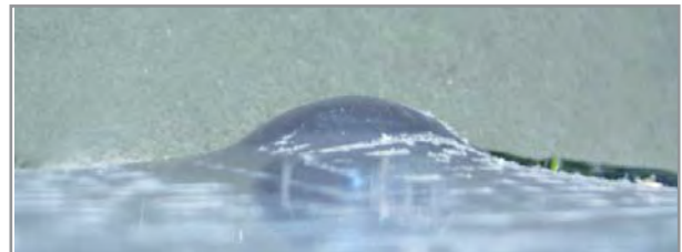
Ideale Auswölbung der Polycarbonatscheibe nach Beschuß
