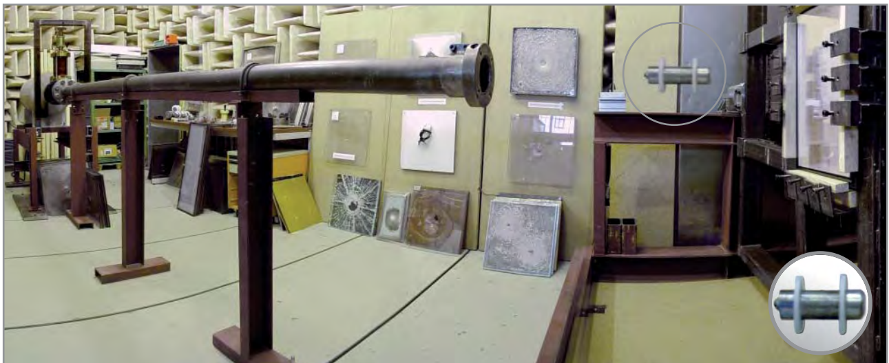
Panoramaansicht des Prüflabors am IWF der TU Berlin. Im Vordergrund Beschleunigungsrohr mit Projektil (vergrößert).
