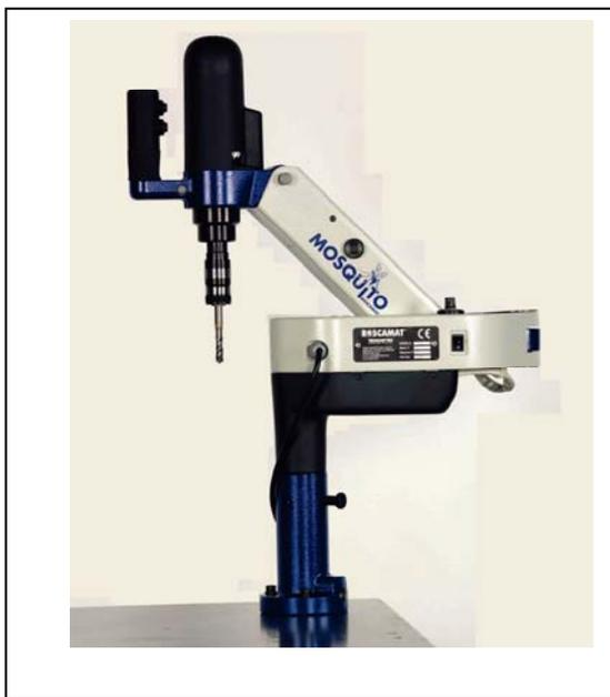
El conjunto de la máquina está formado por un brazo radial unido a un brazo pendular equilibrado mediante un amortiguador de gas interno. En el extremo del brazo pendular se sitúa el cabezal motor que mantiene siempre un desplazamiento perpendicular a su área de trabajo.
