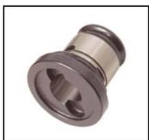
Cuando por cualquier razón (tipo de material, recubrimiento, tratamiento térmico, etc.) debemos roscar métricas pequeñas a baja velocidad, podemos hacerlo por medio de los **casquillos reductores** que transforman el diámetro de acoplamiento del módulo (90, 170 – modelos neumáticos- o 40, 75, 140 – modelo electrónico) a las medidas de los portamachos tipo-1 o tipo-2, según convenga.
