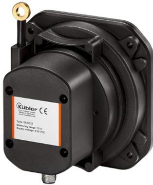
Der Seilzuggeber D125 ist mehr als ein Sensor zur Ermittlung von längenbezogenen Positionsdaten. Varianten mit integriertem Neigungssensor sowie redundanten Schnittstellen bieten vielseitige Einsatzmöglichkeiten. Die berührungslose magnetische Positionsabtastung, eine hohe Schutzart IP67 und der weitere Temperaturbereich runden das Produkt ab.
