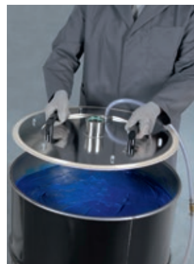
Montage Nachfolgeplatte mit Prozessdichtung.*
