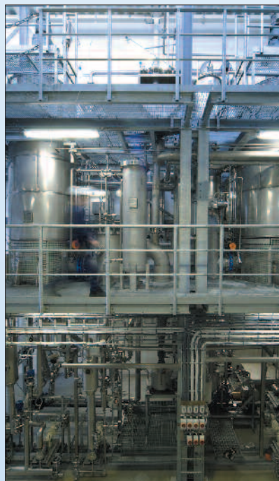
Planta de evaporación de trayecto corto para la concentración de ácidos grasos Omega-3
