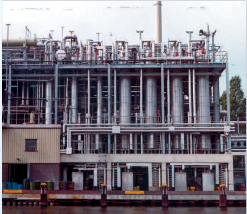
Planta de evaporación de múltiple efecto en película descendente para la destilación de micela
