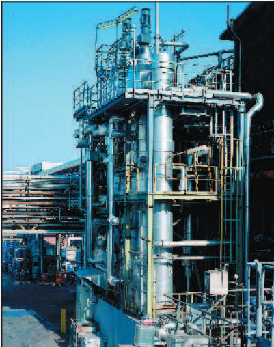
Planta con 2 etapas de evaporadores de capa fina para la concentración de resina
