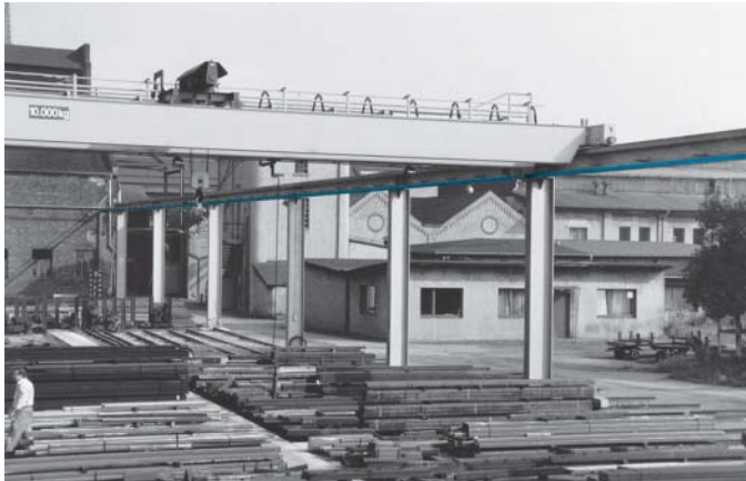
Conducción LSV en un almacén de hierros.
