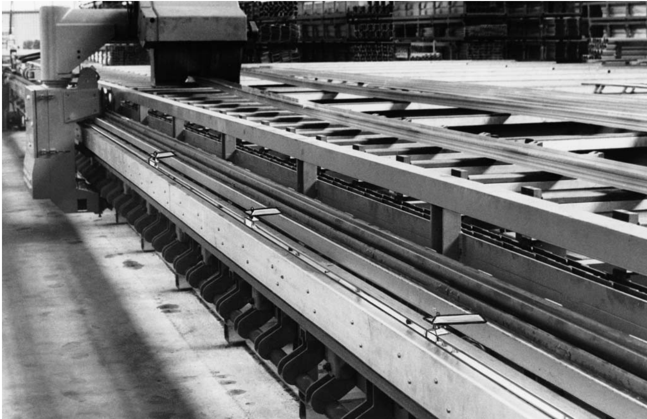
Conducción LSVG en un banco de estiraje
