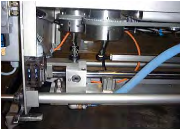
Bild 51.1: igubal®-Gelenkköpfe in einer Pralinengarnieranlage
