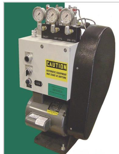
Compresor de alta presión para llenado de cilindros a 152-207 bar
