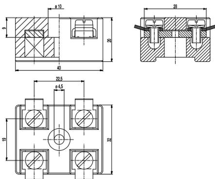
Die Anreih-Flachklemmleisten 560 bestehen aus Steatitsockeln und verdrehungssicher befestigten Flachklemmen ähnlich DIN 41000. Die verschiedenen anderen Ausführungen sind in der Tabelle beschrieben. Die Klemmleisten können auf einer Tragschiene oder auch einzeln eingesetzt werden. Der Sockel besitzt bodenseitig eine Längsnut zur unverdrehbaren Befestigung auf Tragschienen 16 x 3 mm. Die Flächen neben dem Anschraubloch können zur Beschriftung verwendet werden.
