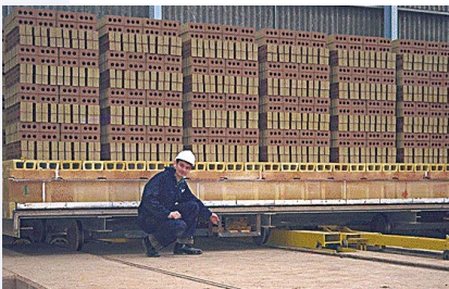
Kiln Tracker System unter dem Ofenwagen zur Überwachung der Ziegel
