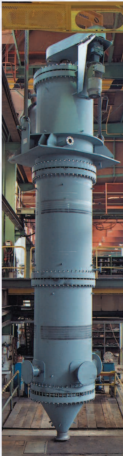
Dünnschichtverdampfer vor dem Test im Prüfstand
