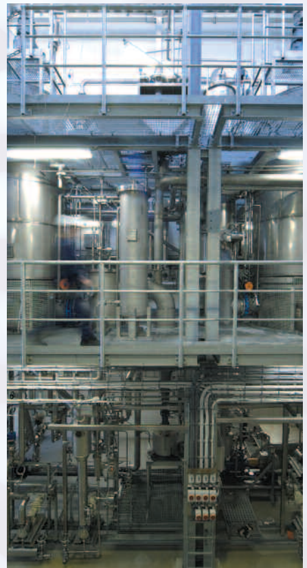
Omega-3-Fettsäuren-Destillation mit Kurzwegverdampfersystem
