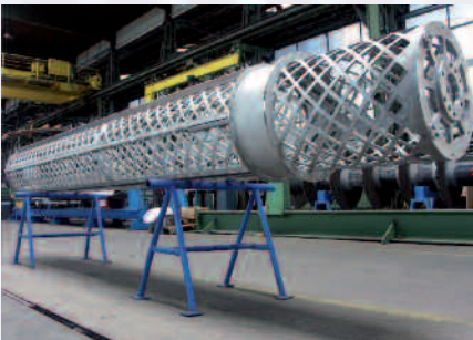
Rotor mit radial beweglichen PTFE-Wischerelementen
