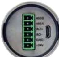
Thermalert 4.0 6-Fils avec bornier de raccordement. Communications analogique et digitale RS-485
