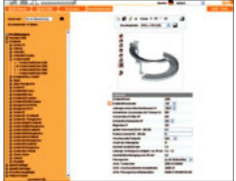
Erstellung der 3D-CAD-Modelle nur durch Eingabe der Drehwinkel, ohne komplizierte Berechnung der Kettenlänge
