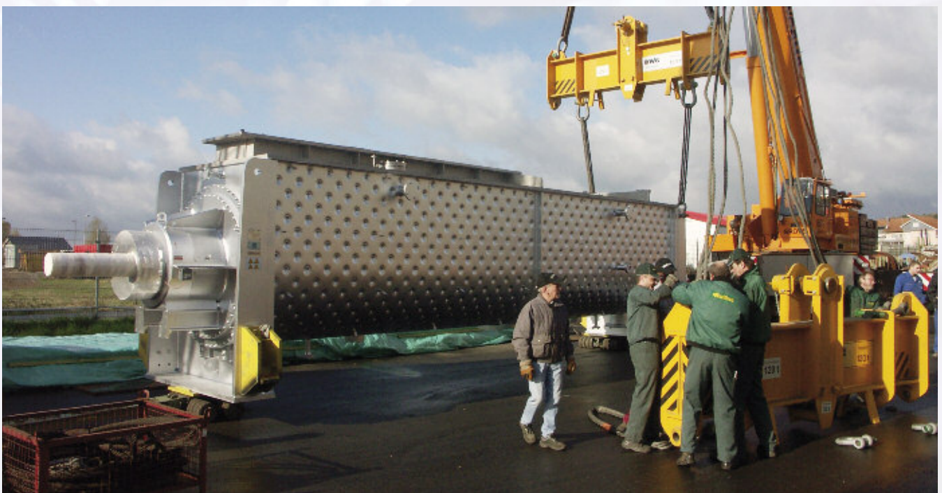
Verladung eines ROVACTOR® für die Terephthalsäure-Trocknung
