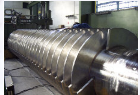
Rotor für einen Terephthalsäure-Trockner
