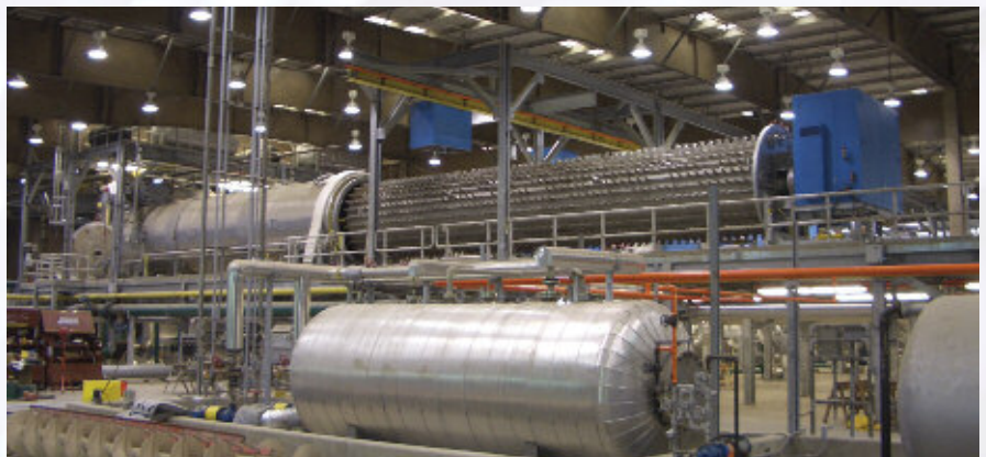
Klärschlammrockner mit ausgefahrenem Rotor
