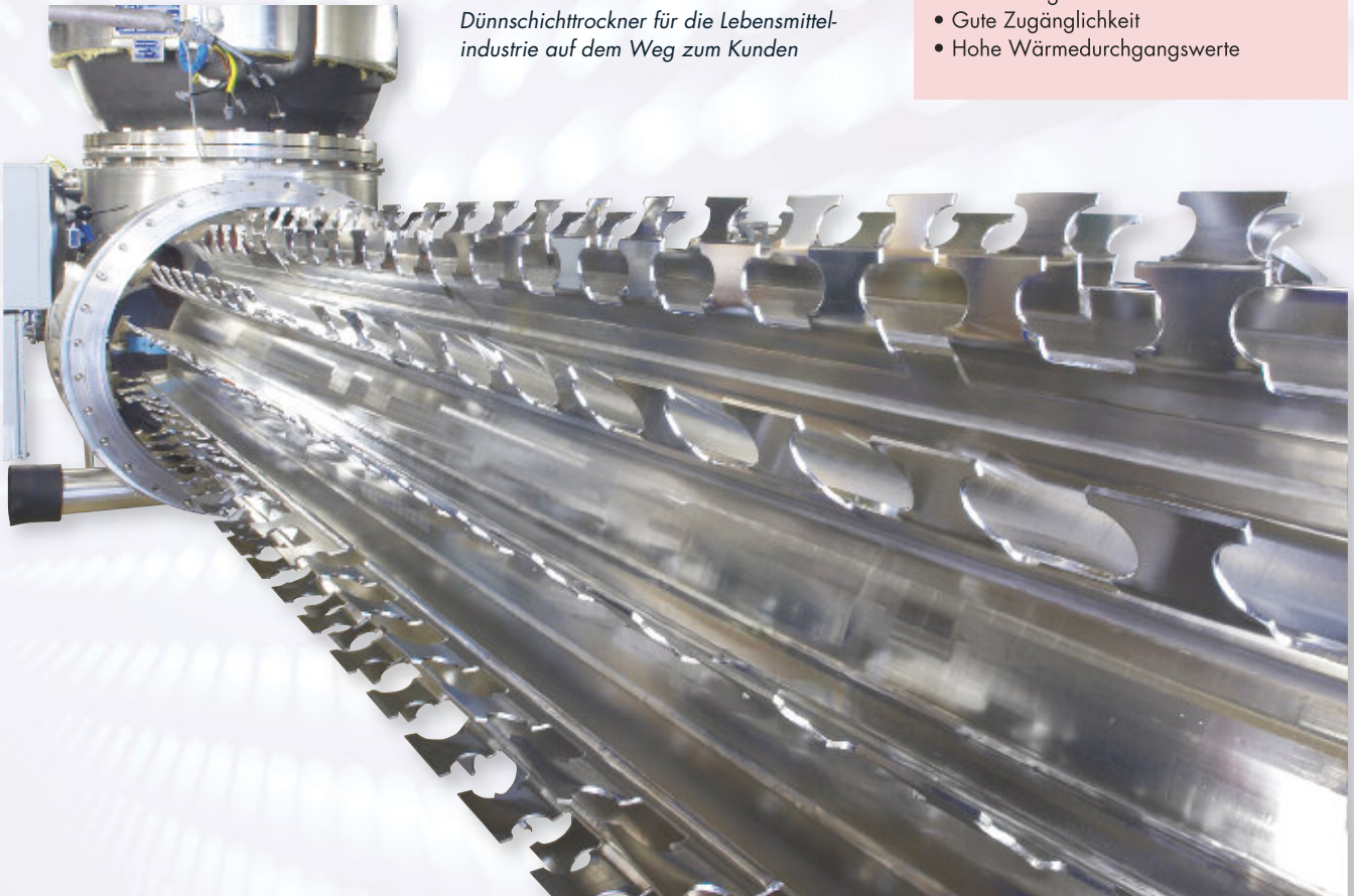
Horizontaler Dünnschichttrockner mit ausgefahrenem Rotor
