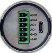
アナログ出力とRS-485通信に対応した6ピン端子台仕様の Thermalert 4.0
