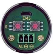
Thermalert 4.0 は、2線式配線で電源供給とアナログ出力を同時にサポート
