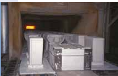
Sistema Kiln Tracker en un horno con rodillos para muebles sanitarios
