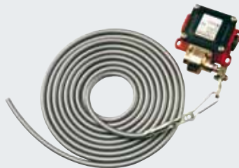
Dragströmbrytare med plastlina Monteras horisontellt eller vertikalt. Kapsling i pressgjuten aluminium, IP 65, linlängd 4 m
