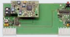
Mottagare HER 1 (1 kanal) med potentialfri reläutgång i separat hus utan anslutningsledning eller som instickskort i styrskåpet.
