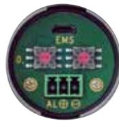
Thermalert 4.0 que soporta lazo de comunicaciones a 2 hilos para fuente de alimentación y salida analógica simultáneas
