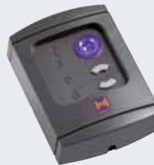
Inomhusbrytare IT 3b Förutom den stora, belysta öppningsknappen har inomhusbrytaren IT 3b två knappar till. Med dem tändes man maskineribelysningen och kopplar ifrån maskineriets fjärrsystem helt, t.ex. under semestern (för SupraMatic).
