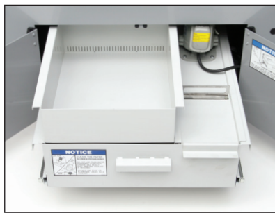
OM-2A har en utdragbar kylvätsketank och pump i maskinens sockel.
