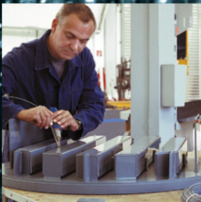
Fertigung eines Tunnelbodens aus Kunststoff
