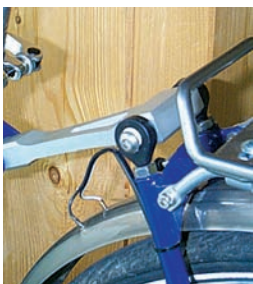
igubal® Gömbcsuklók a kerékpár hátsó rugózási mechanizmusában
