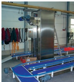
igubal® Gömb Támcsapágyak az élelmiszeriparban használt szállítószalagban
