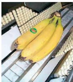
igubal® Gömbbetétek egy szállítószalag felépítésében
