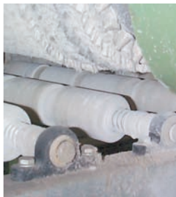
Korrózió, szennyeződés és karbantartás kiküszöbölése megoldható az igubal® Gömb Támcsapágyakkal
