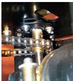
igubal® Peremescsapály egy külső takarítógép hajtómeglyén
