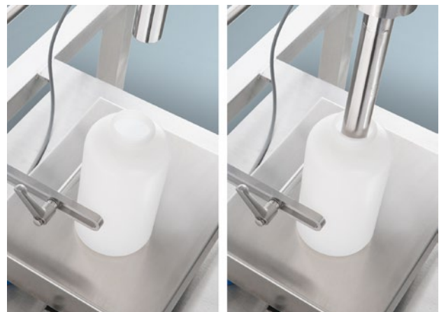
Anschlag zum einfachen Positionieren des Gebindes.
