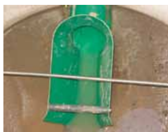
Šachtový žlab dostupný od DN 100 ( Q_{\max} 5,7 l/s) do DN 300 ( Q_{\max} 94,4 l/s)
