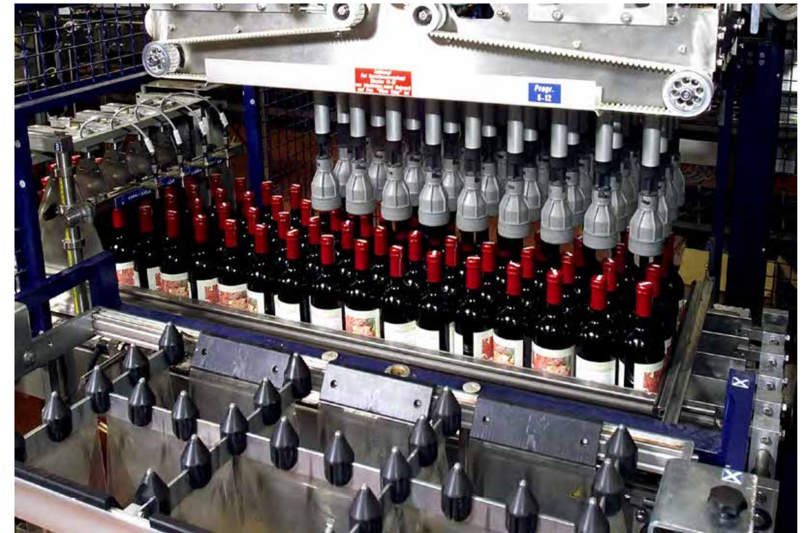
Cabezal de agarre de regulación mediante husillo para el procesamiento de diferentes diámetros de envases
