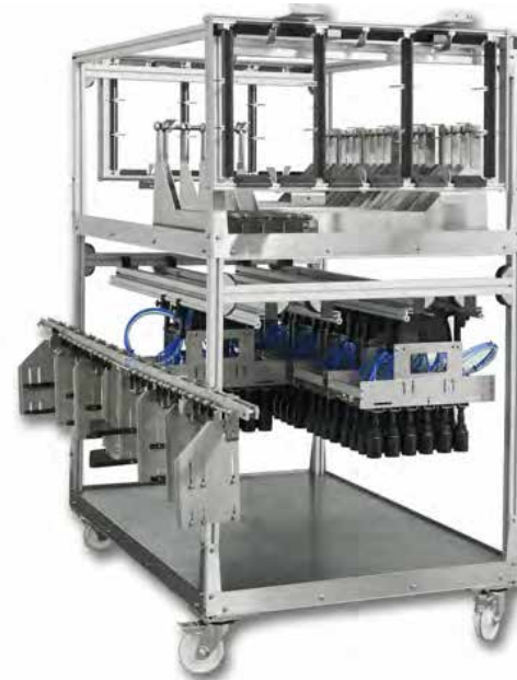
Cabezal de agarre de regulación mediante husillo para el procesamiento de diferentes diámetros de envases
