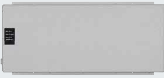
Nepřerušitelný napájecí zdroj USV k překlenutí výpadků napětí do 4 hodin, bezpečnostní zařízení, signální světla atd. zůstávají v provozu, indikace stavu pomocí LED, automatický test baterie, přepětový filtr, Rozměry: 560 x 235 x 260 mm (š x v x h), Stupeň ochrany krytem: IP 20
