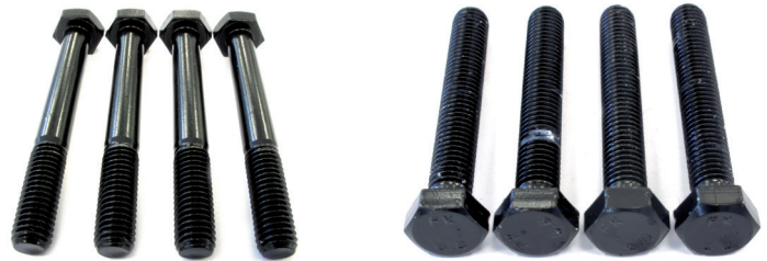
KTL-Topcoat DELTA-eLACK® 800 auf DELTA-PROTEKT® Zinklamelle (links) und auf DELTA-PROZINC® (rechts) nach 1.600 Stunden im SST
