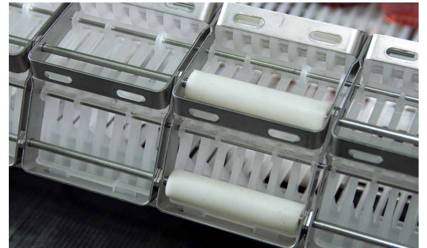
Parte baja de la cinta transportadora Marathon Belt
