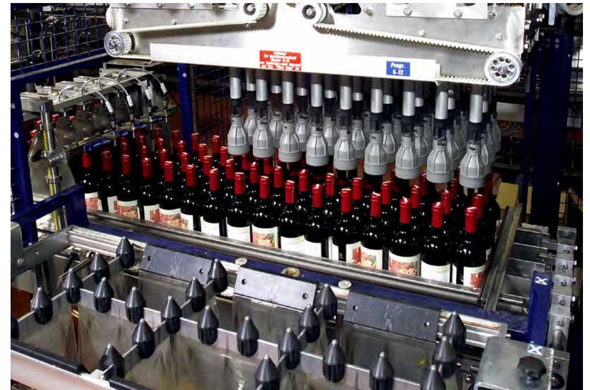
Spindelverstellbarer Greiferkopf zur Verarbeitung unterschiedlicher Behälterdurchmesser
