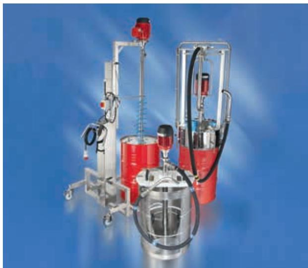
Les systèmes de vidange de fûts VISCOFLUX ont été spécialement conçus pour vider les fûts à couvercle avec des fluides à haute viscosité. Les pompes à vis hélicoïdale excentrée FLUX permettent un pompage continu et particulièrement doux. Tous les systèmes permettent d'avoir une vidange du fût quasiment intégrale avec une quantité résiduelle < 1 % (inférieure à 2 % pour les fûts avec emballage souple).
