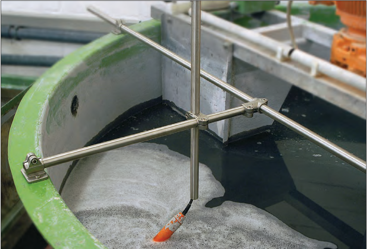
Einfache Sondenhalterung in agressiver Umgebung.
