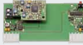
Ricevitore HER 1 (monocanale) con uscita a relè a potenziale zero, alloggiato in una custodia separata senza cavo di collegamento oppure con scheda ad innesto sul quadro elettrico.
