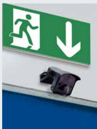
Segnalatore radar per il controllo della zona critica, quale equipaggiamento di serie
