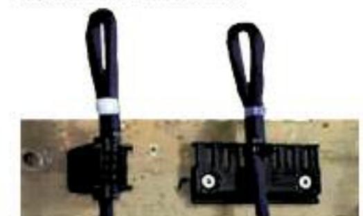
Prova di resistenza alla trazione con cavi igus® chainflex®
