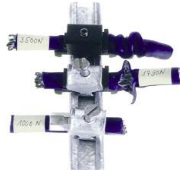
Test igus®: confronto fra 3 diverse tipologie di staffe fissacavi - Risultato finale: Le staffe chainfix dimostrano una resistenza alla trazione triplicata rispetto ai fissacavi tradizionali.
