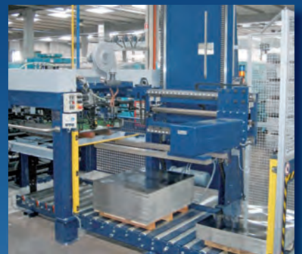
Semi-automatischer Palettenwechsler in der Tafelzufuhr einer Lackierlinie
