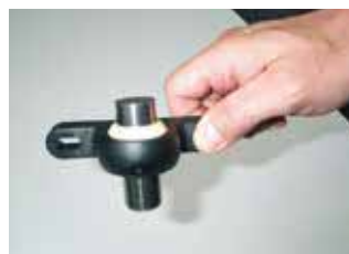
Misura corretta del diametro interno con tampone passa/non passa
