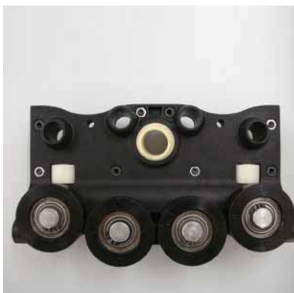
Carrello di un sistema di gru
