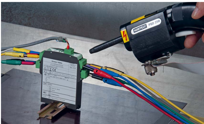
Prüfung eines SINEAX V604s auf Störfestigkeit gegen elektrostatische Entladungen (ESD)
