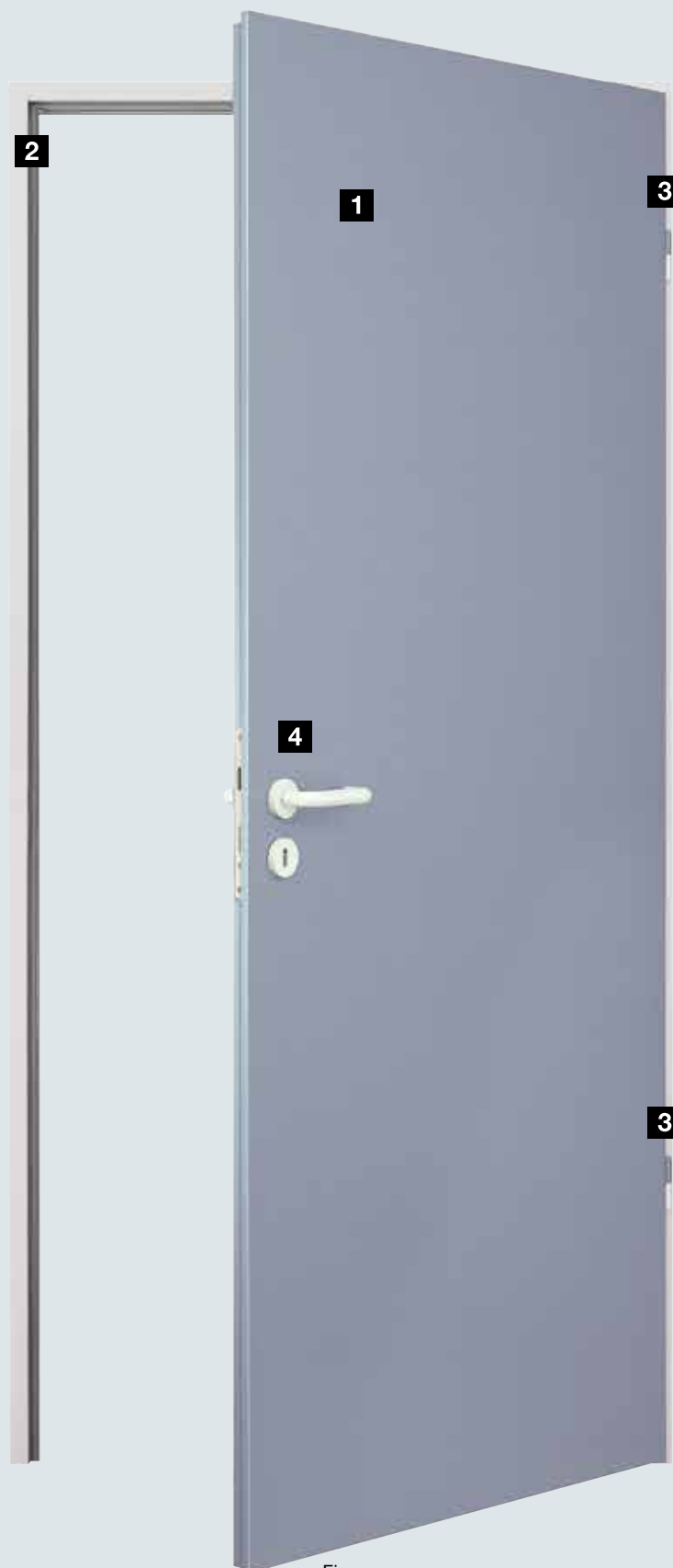
Figura: Porta ZK trattata con mano di fondo a polveri color grigio finestra (RAL 7040) con corredo di rosette bianche (equipaggiamento speciale) da prevedere in fase d'ordine.
