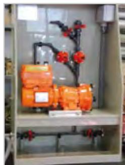
Skid di dosaggio latte di calce con pompa peristaltica 48l/h a 8 bar
