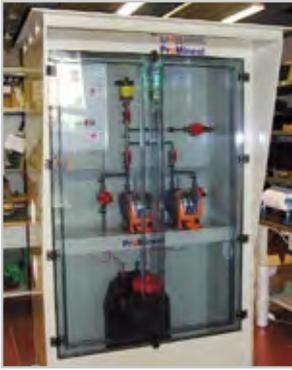
Skid di dosaggio ipoclorito di sodio con protezione anti schizzi e tetto ventilato
