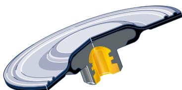
Membrana composita DEVELOPAN® . EPDM di alta qualità con rinforzo in tessuto, anima in acciaio vulcanizzato e rivestimento in PTFE sul lato a contatto con il fluido. È garanzia di una lunga durata di funzionamento, elevata resistenza ai prodotti chimici, utilizzo in ampio range di temperatura sino alla contropressione di 16 bar.
