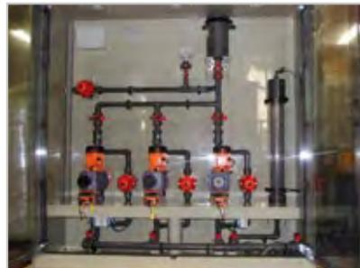
Skid di dosaggio idrossido di sodio con cilindro di calibrazione, pompe dosatrici a motore e polmone smorzatore
