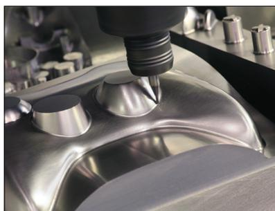
Il mandrino Inline con azionamento diretto e 12 000 giri/min Haas unitamente al comando ad alta velocità Haas con funzione "Look Ahead" garantisce precisione e qualità superficiale come richiesto dai costruttori di stampi ed altre industrie di alta precisione.
