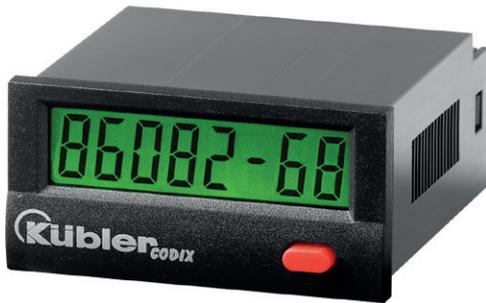
Der Codix 134 ist ein batteriebetriebener einfacher Betriebsstundenzähler für PNP, NPN und Hochvoltanwendungen. Verschiedene Zeitbereiche werden über die 7-stellige LCD-Anzeige mit optionaler Hinterleuchtung dargestellt.
