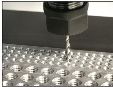
Il mandrino cono BT30 direttamente accoppiato prodotto da Haas viene azionato 12 000 giri/minuto per consentire una fresatura ad alta velocità e una maschiatura rigida a velocità che raggiungono i 5 000 giri/minuto.
