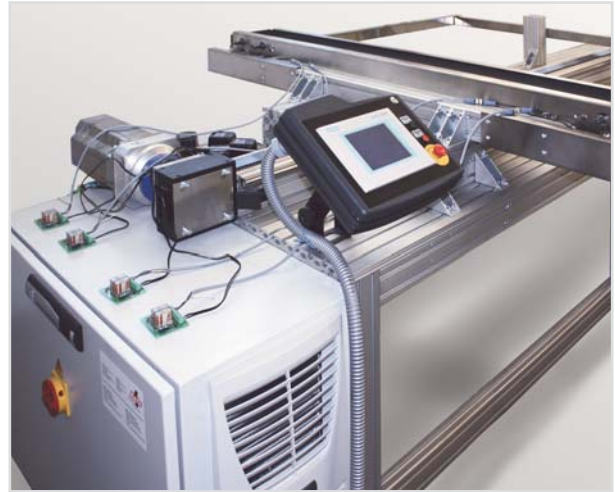
Mechatroniktest - Prüfung von Mechanik und Sensorik
