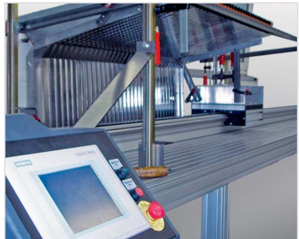
Verfahrttest Vectorfaltenbalg auf hohe Beschleunigung bis 4g
