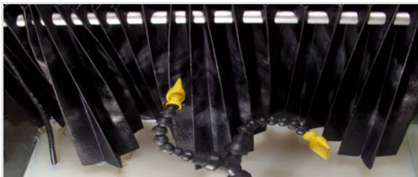
Materialbelastungstest - Kühlmittelsprühversuch, rotierende Düsen
