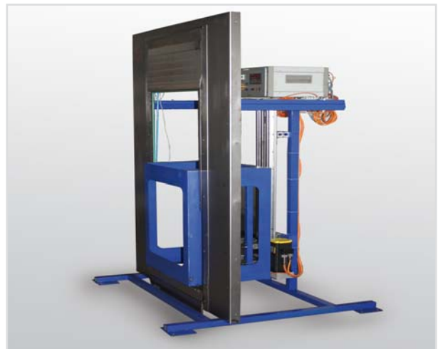
Systemtest Z-Achse mit Prüfung von Pneumatikkomponenten und Führungsschienen
