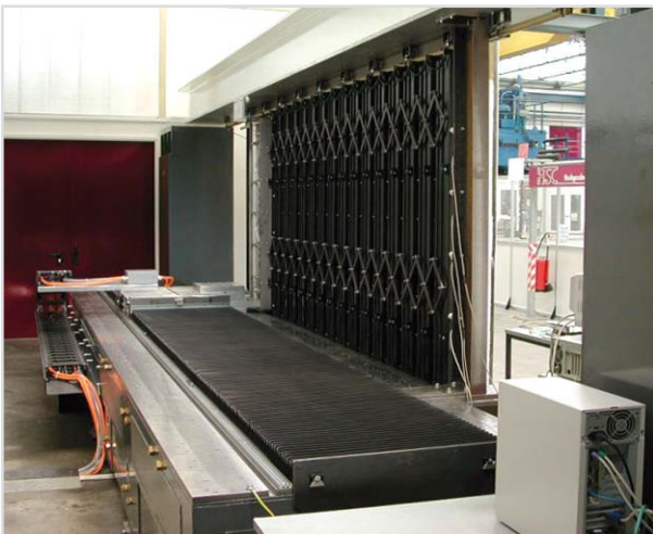
Verfahrttest Lamellenabdeckung mit Scherensystem am PTW, Kraftsensoren messen Schwingungen beim Verfahren auf Blockmaß
