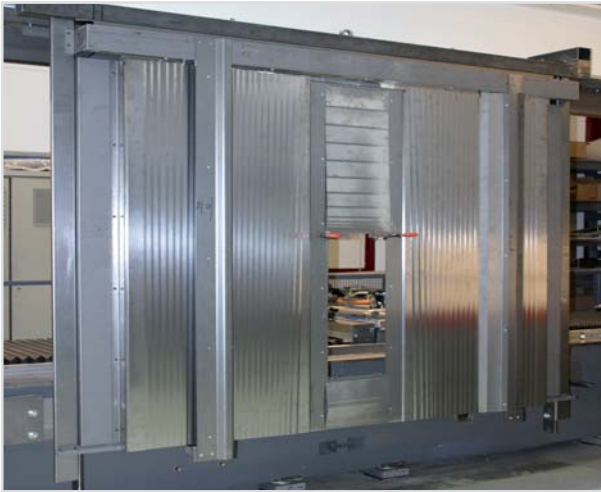
Funktionstest einer kompletten Rückwand am Hochgeschwindigkeitsprüfstand PTW auf Anpressdruck und Geräuschentwicklung
