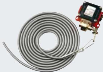
Træklinekontakt med kunststof-trækwire Mulighed for vandret eller lodret montering, trykstøbt alu-kabinet, IP 65, wirelængde 4 m
