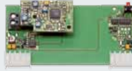
Modtager HER 1 (1 kanal) Med potentialfri relæudgang i separat kabinet, uden tilslutningsledning, eller som printplade i styreskab
