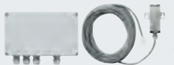
2-Kanal Relais-Empfänger HER 2 mit 2 potentialfreien Relais- Ausgängen, Frequenz 868 MHz, IP 65, Betriebsspannung 24 V DC/230-240 V AC, separate Antenne für den Außeneinsatz (IP 65), im sabotagesicheren Alu-Gehäuse, mit 7 m Anschlus- sleitung, 3-adrig, Auswerteeinheit für den Innenbereich
