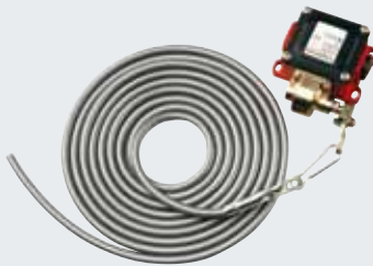
Snortrekkbryter med snor i kunststoff Kan monteres vannrett eller loddrett, støpt aluminiumsboks IP 65, snorlengde 4 m
