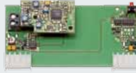
Mottaker HER 1 (1 kanal) med potensialfri relé-utgang i separat boks uten tilslutningsledning eller som kretskort i styreskap.
