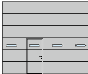
SPU F42, SPU 67 Thermo Sandwich-vindu type D Plassering av gangdør til venstre
