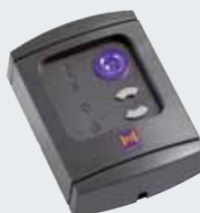
Innvendig bryter IT 3b I tillegg til den store, belyste tasten for enkel åpning av porten, har den innvendige bryteren IT 3b to ekstra taster. Med disse betjenes portåpnerbelysningen og slår av radiofunksjonen på portåpneren fullstendig, f.eks. i ferietiden (på SupraMatic).
