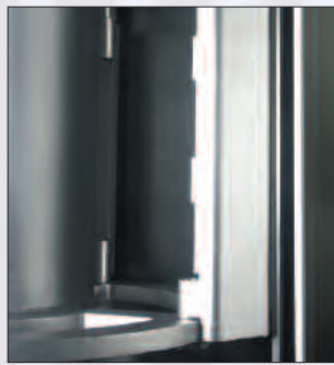
Rotor mit pendelnd aufgehängten Wischerblättern aus Metall
